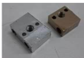
Figura 2 - Hotend original (direita) e Hotend produzido (esquerda).
