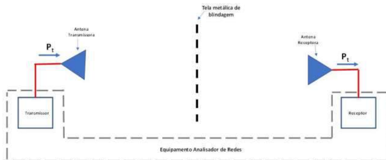
Figura 3: Diagrama da montagem para ensaios. Fonte: Próprios autores 2022.
